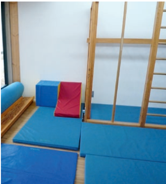
Abb. 46: Bei diesem Gerät besteht die Gefahr des Aufpralles auf kleinflächige, harte Teile. Die Matten sind z. T. ungeeignet und nicht gegen Verrutschen gesichert.
